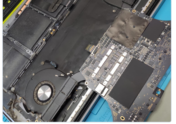
Görsel 2.2: Soğutma üniteleri ve fan ızgaralarındaki hava kanallarının tıkanma boyutu.
